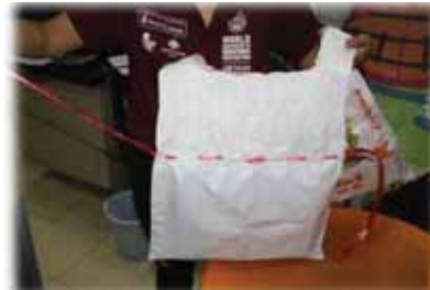
ใช้เชือกเย็บกระสอบทั้ง 2 ใบบริเวณเหนือขอบ ด้านบนที่เย็บอยู่เดิม เพื่อเป็นสายรัดด้านข้าง (มีระยะห่างที่สามารถใช้รัดให้พอดีตัว)
